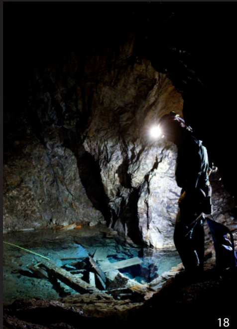
18. Dans l'eau, les boisages des puits se dégradent très lentement et sont encore partiellement visibles comme ici dans la mine Saint-Jacque Lorraine (c) Photo Jean-François Ott / ASEPAM
